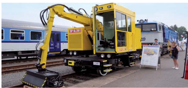
CZ LOKO je nejvýznamnějším výrobcem speciálních kolejových vozidel v Česku. Na snímku jedna z posledních novinek - strojní vytahovák pražců SVP 60.2.
