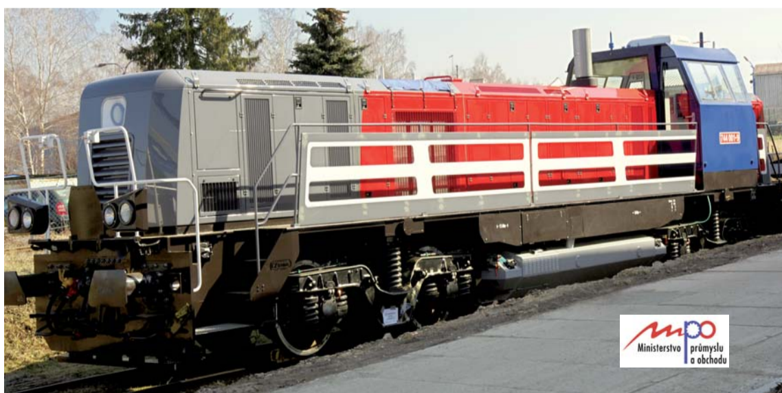
Modulová čtyřnápravová dieselelektrická lokomotiva 744 v České Třebové čeká na kabínu s novým designem
