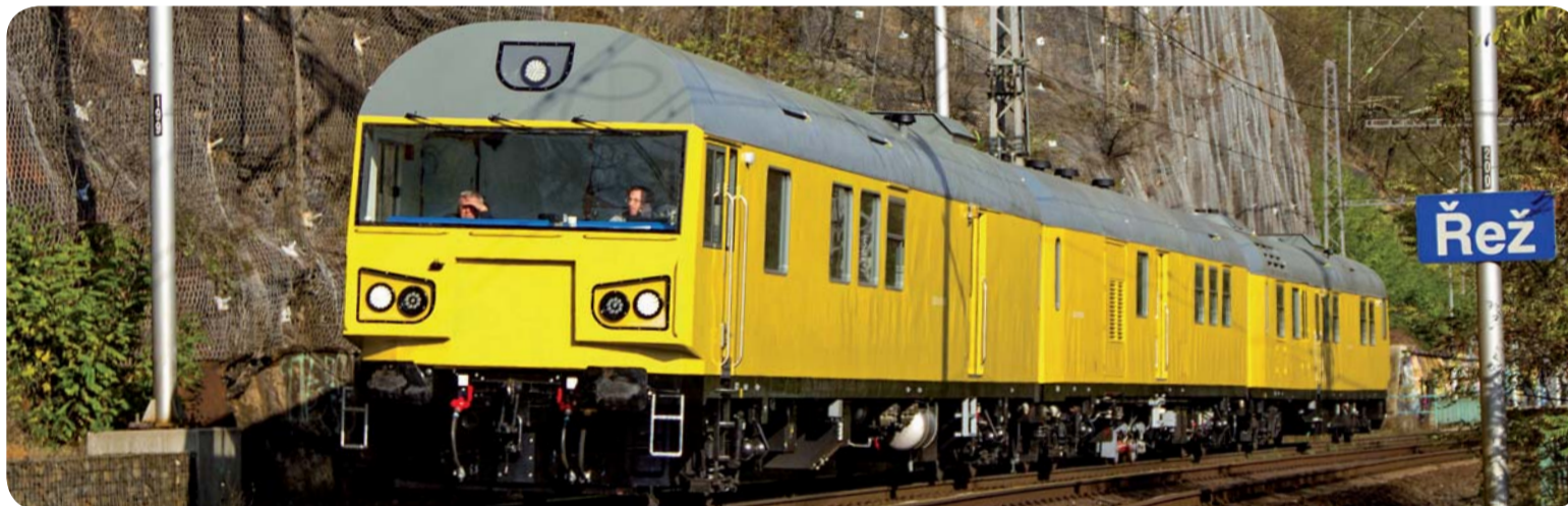
Unikátní motorová jednotka defektoskopické kontroly DJ-NDT vznikla modernizací a přestavbou dvou poštovních vozů typu PostW a motorového vozu 850/851. Skládá se ze tří vozů – řídicího, měřícího a hnacího a určena je na kontinuální měření vad kolejnic za pomoci nedestruktivních metod. Pro společnost CZ LOKO, kde vznikala, to znamená další posílení know-how v oblasti speciálních diagnostických a interiérových vozidel.
