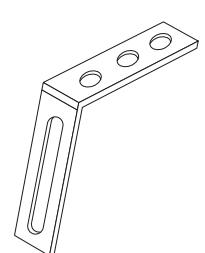
Bežný profil, ktorý sa používa na spájanie drevených alebo kovových castí. Dôležité je to, že na jednom ramene má bežné otvory na skrutky, na druhom má však pozdĺžny otvor. Ten nám potom pomôže pri nastavovaní napnutia drôtu.
