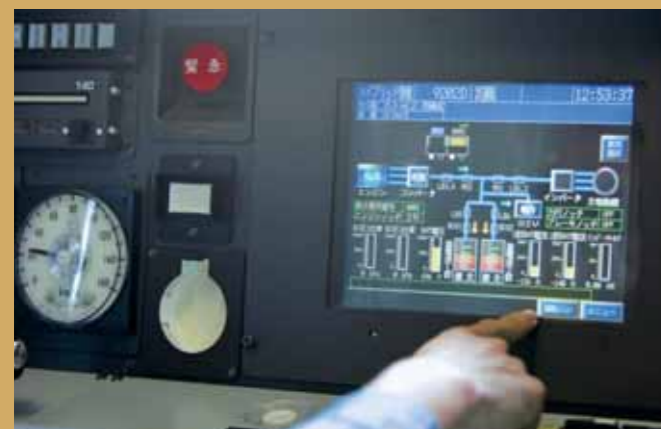
Nový hybridný vlak Kiha E200 má nadštandardne vybavenú aj kabína rušňovodcu, ktorý môže sledovať prácu hybridného pohonu na dotykovom monitore palubného počítača. Snímky SITA/AP
