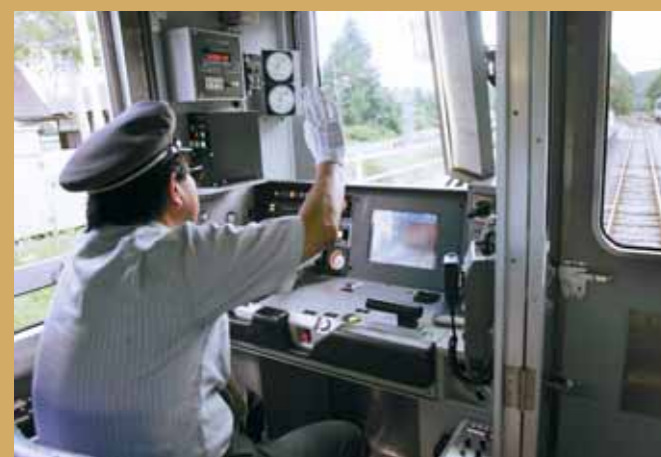
Nový hybridný vlak Kiha E200 má nadštandardne vybavenú aj kabína rušňovodcu, ktorý môže sledovať prácu hybridného pohonu na dotykovom monitore palubného počítača. Snímky SITA/AP
