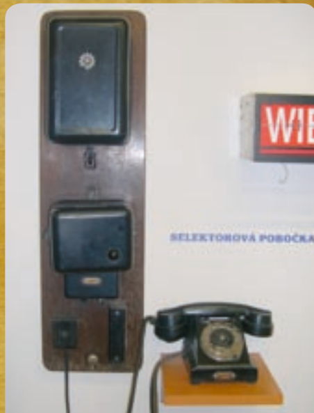
Pobočná stanica decentralizovaného selektoru typu Prchal-Ericsson.
