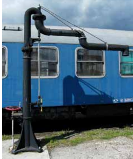
Vodný žeriav typu Oldenburg pre hlavné trate so zdvojeným výtokovým ramenom zo Skalitého v expozícii Výchrevne Vrútky.
