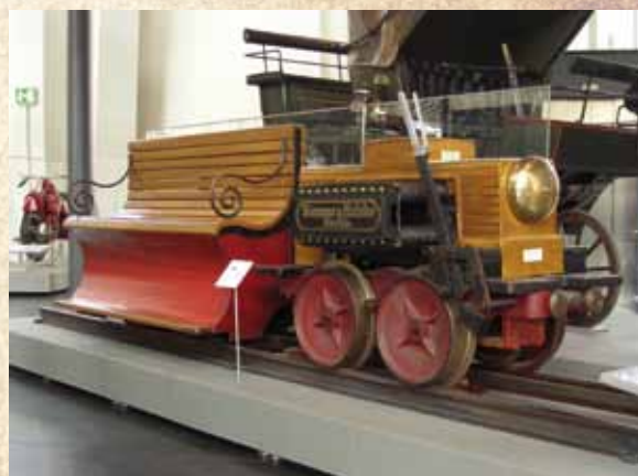
Siemensov vynález bol malej a zavalitej konštrukcie, s dĺžkou len 1,5 metra. Základ stroja tvoril trakčný elektromotor s výkonom 2,2 kW, ktorý bol spojený s jednoduchým podvozkom.
